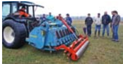
De Imants-schudbeluchter wordt gewoonlijk ingezet op sportvelden. In proeven blijkt het apparaat ook goede resultaten te geven op grasland. De schudbeluchter breekt de verdichte grond en brengt lucht in de grond. De worteldiepte neemt toe en de verdichting verdwijnt. Ook de graslandwoeler van Agro-Evers geeft goede resultaten.
