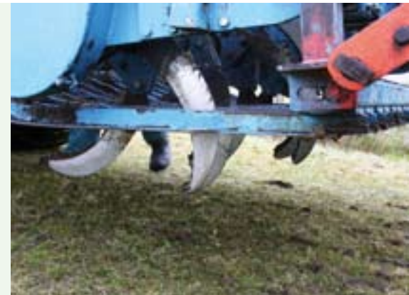
De Imants-schudbeluchter wordt gewoonlijk ingezet op sportvelden. In proeven blijkt het apparaat ook goede resultaten te geven op grasland. De schudbeluchter breekt de verdichte grond en brengt lucht in de grond. De worteldiepte neemt toe en de verdichting verdwijnt. Ook de graslandwoeler van Agro-Evers geeft goede resultaten.
